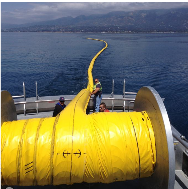
Foto 1: Carretel de Barreiras de Contenção
