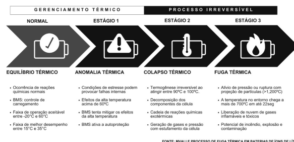
Figura 01 – Processo de fuga térmica a partir de termogênese no ânodo em baterias de íons de lítio.
