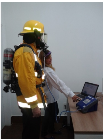
Foto: Ensaio de vedação quantitativo
