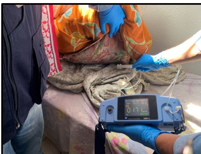
Foto 2 - Detecção de vapores de mercúrio em roupas de cama e colchão.
