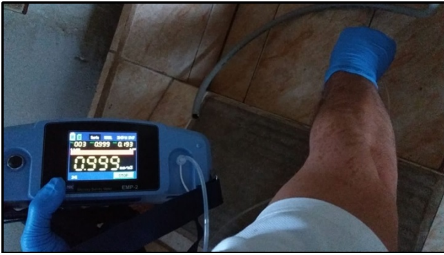
Foto 5 - Detecção de elevada concentração de mercúrio no rejunto do piso no interior de residência.
