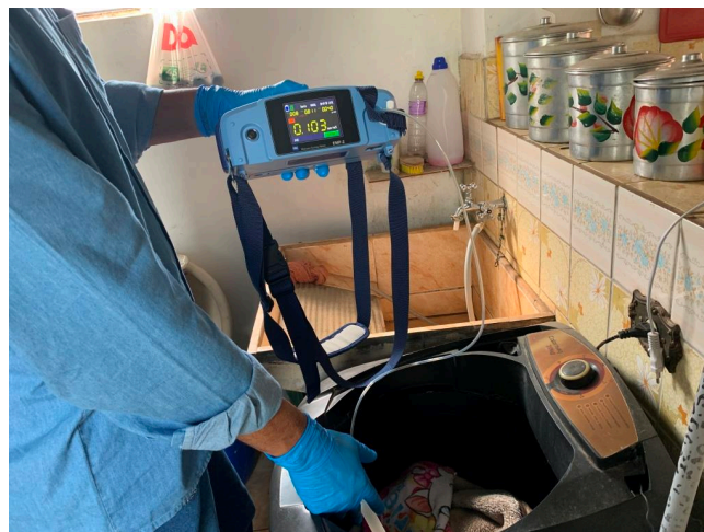
Foto 3 - Detecção de mercúrio metálico em máquina de lavar roupa.
